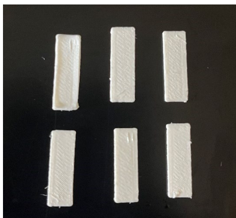
Slika 52. Prikaz TPU pločica nakon testa bubrenja
