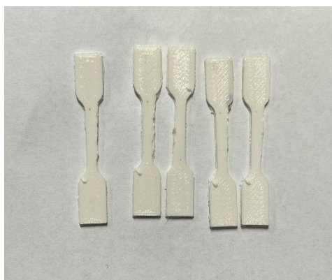
Slika 28. . Prikaz 3D-ispisanih epruveta od TPU pod 0° debljine sloja 0,05 mm
