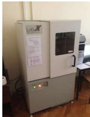
**Slika 9.** XRD difraktometar Shimadzu D600
