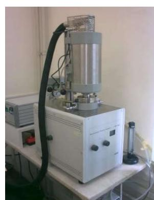
**Slika 10.** Termogravimetar NETZSCH STA 409
