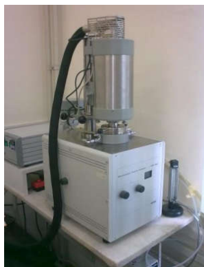
Slika 10. Termogravimetar NETZSCH STA 409
