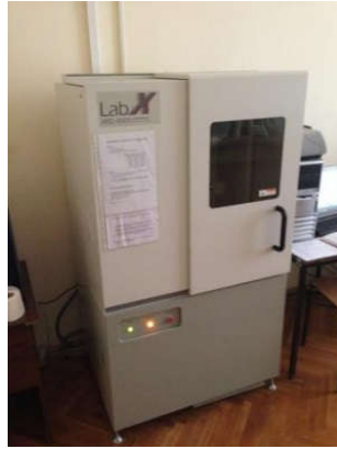
Slika 9. XRD difraktometar Shimadzu D600
