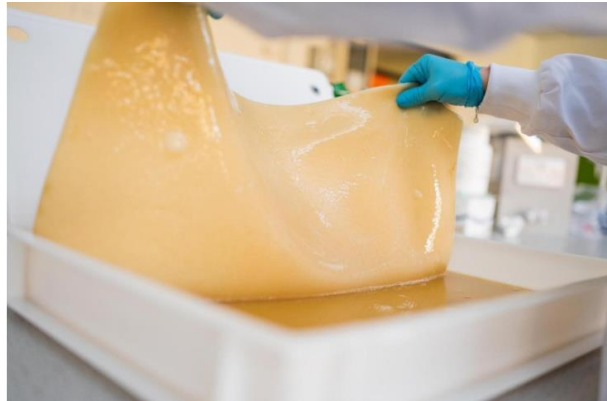
Slika 22. Proizvodnja bakterijske celuloze [57]
