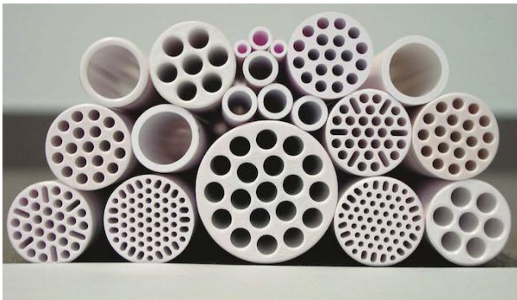
Slika 7. Poprečni prikaz nekih keramičkih nanofiltracijskih membrana [16]
