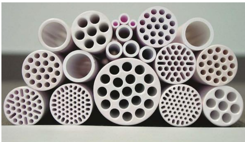
Slika 7. Poprečni prikaz nekih keramičkih nanofiltracijskih membrana [16]
