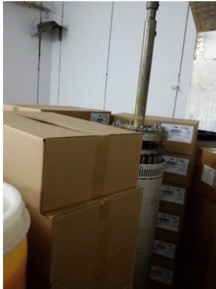
Slika 12. Izvor ^{60}\text{Co} okružen materijalom kojeg treba sterilizirati [19]
