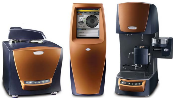
Slika 19. DSC i TGA Discovery uređaji (TA Instruments)
