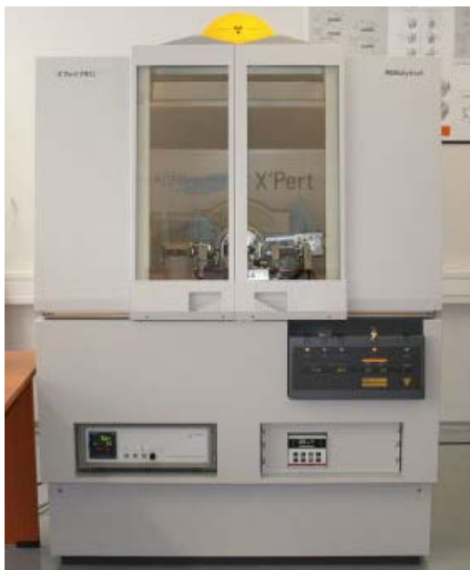
Slika 18. Rendgenski elektroenergetski sustav Philips PANalytical X'Pert Pro MPD
