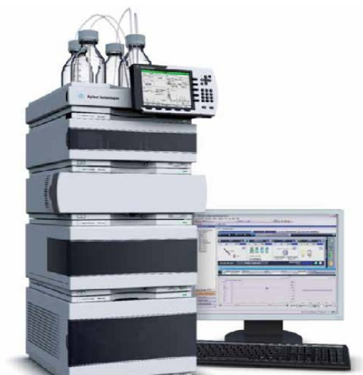
Slika 16. HPLC uređaj Agilent Infinity 1290
