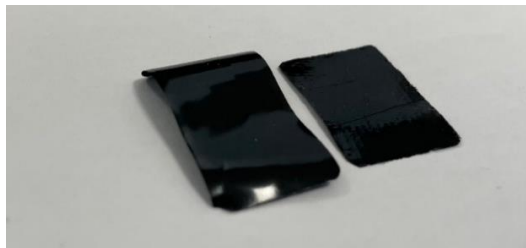
Slika 30. PEDOT- g -PAU:S-SEBS prije i nakon procesa samozacjeljivanja pod opterećenjem
