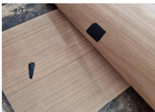
Slika 22. Prepolovljeni film na teflonskoj podlozi prije stavljanja u prešu
