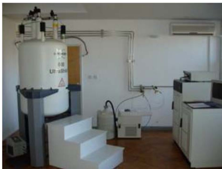
Slika 15 ^1\text{H} NMR Spektrometar Bruker Avance 300
