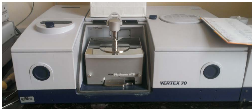
Slika 13 Spektrometar Bruker VERTEX 70
