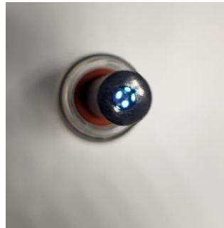
Slika 23: GC elektroda modificirana berlinskim modrilom (60 min depozicije)
