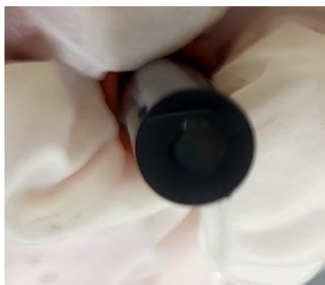
Slika 17. čista elektroda od staklastog ugljika [36]
