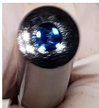
Slika 18. Elektroda od staklastog ugljika modificirana berlinskim modrilom
