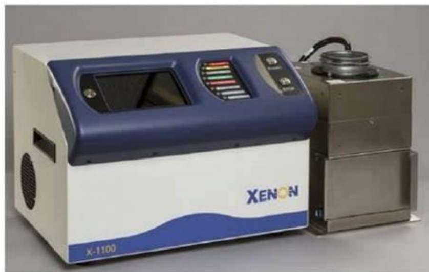
Slika 16. IPL sustav Xenon X-1100 za fototermalno sinteriranje [35]
