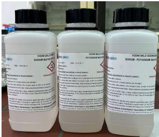
Slika 10. Na + , K + , te Na + /K + vodena stakla
