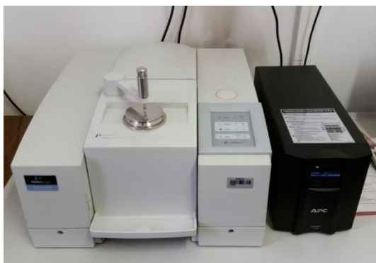
Slika 11 FTIR spektrometar, Perkin Elmer Spectrum One Spectrometer s ATR modulom
