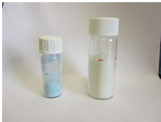
Slika 5 Prikaz obojenog Expancela te usitjenih PLA granula
