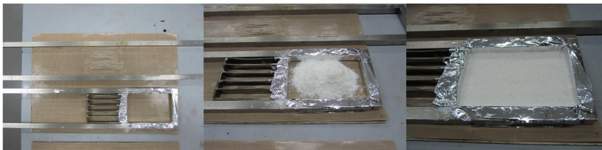
Slika 10 Priprema kalupa za prešanje smjese PLA/EXP
