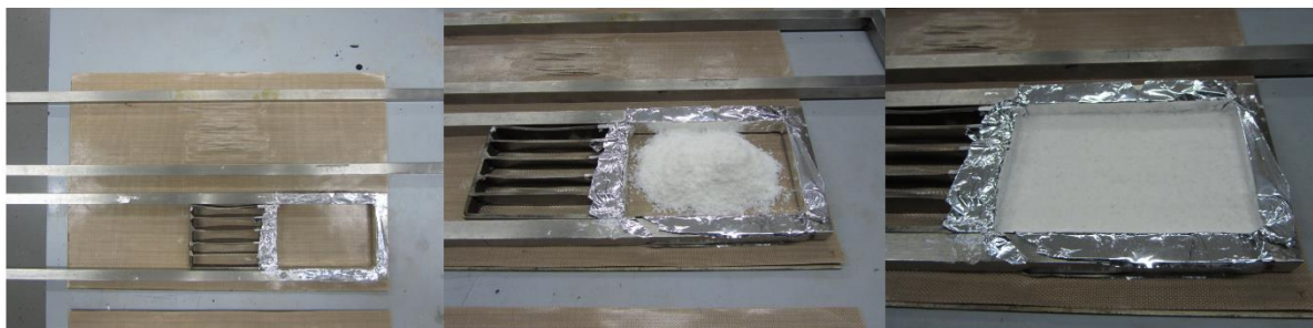
Slika 10 Priprema kalupa za prešanje smjese PLA/EXP
