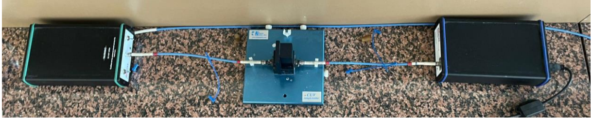
Slika 2.5: Fotografija spektrofotometra Avantes AvaLight-DHc
