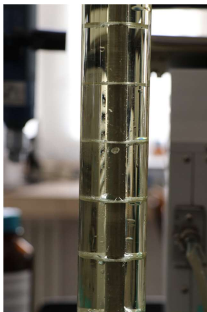
Slika 17. Prikaz kolone ispunjene uljem
