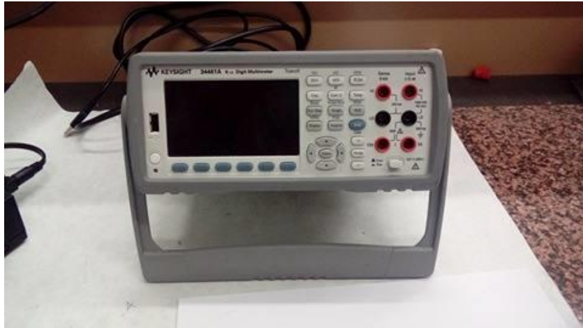
Slika 13. Uređaj za mjerenje električnog otpora Keysight 34461 6 1/2 Digit Multimeter
