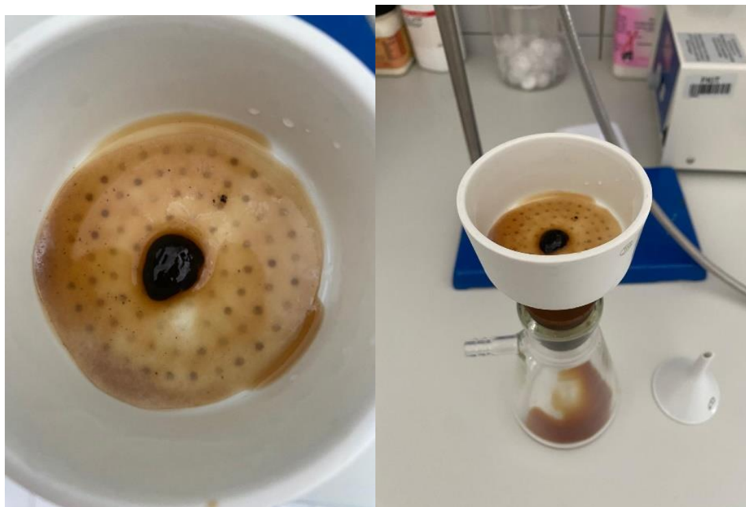
Slika19.: Filtracija produkta s Büchnerovim lijevkom
