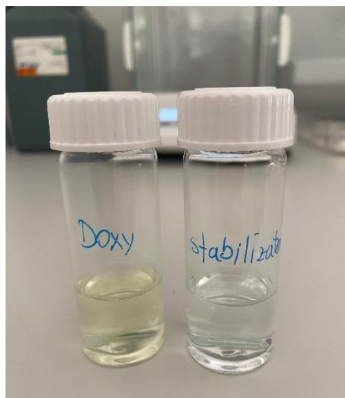
Slika17.: Doksiciklin i stabilizator otopljeni u 10mL destilirane vode
