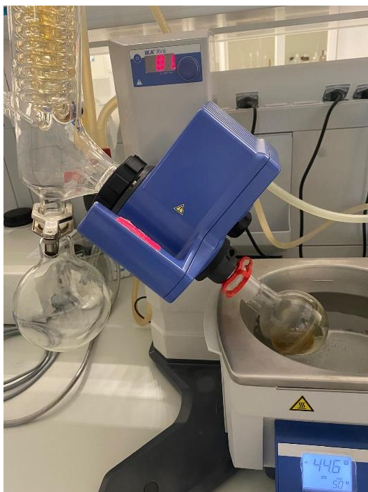
Slika 15.: Okrugla tikvica spojena na rotavapor otapala
