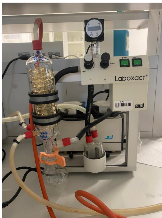
Slika 9.: Vakuumski sustav LABOXACT® kupka
