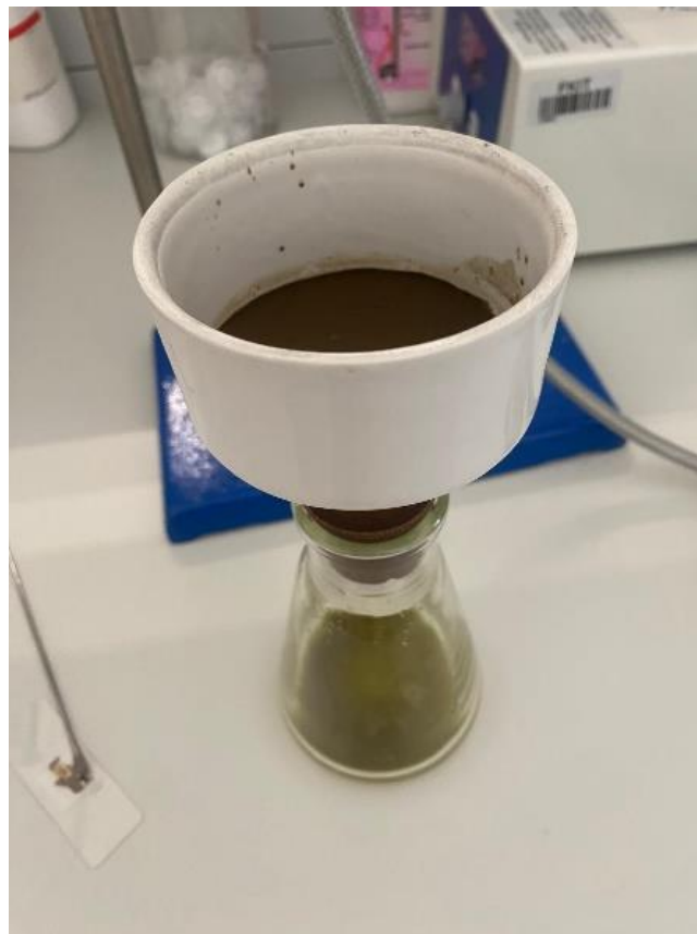
Slika 22.: Filtrat dobiven nakon filtracije kroz Büchnerov lijevak
