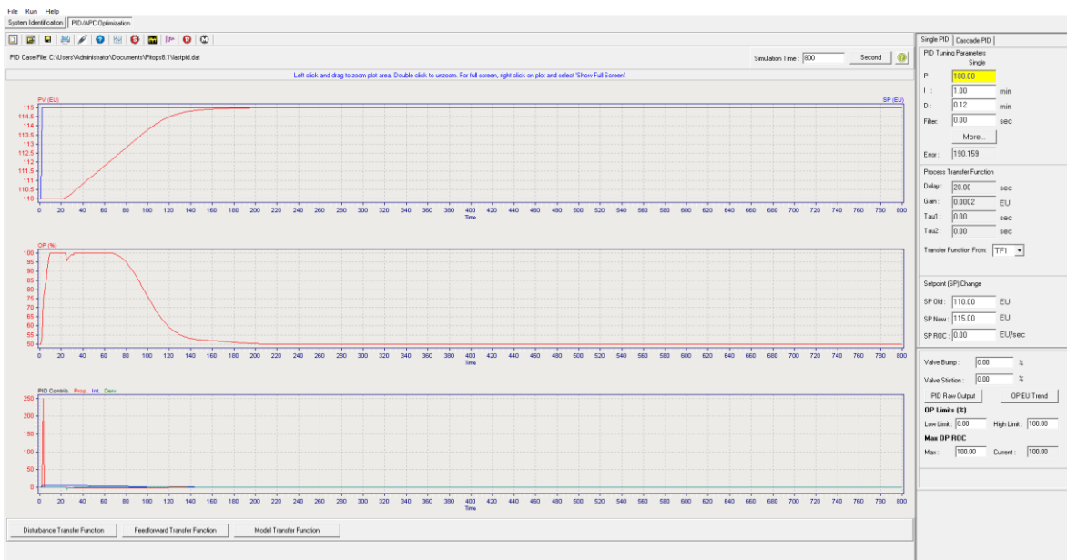
Slika 18. Simulacija djelovanja regulatora temperature u reaktoru BT – 30
