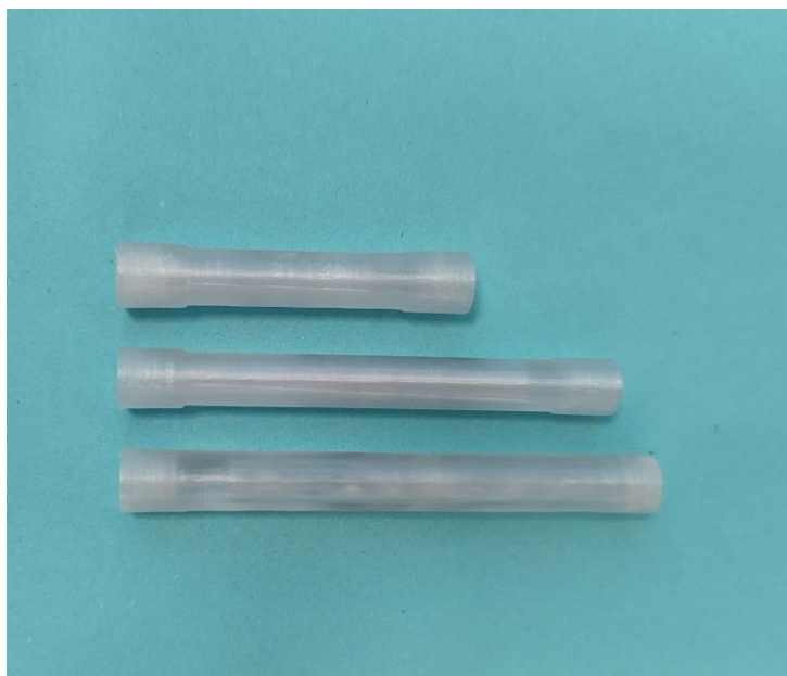
Slika 19. 3D-tiskani cijevni reaktori volumena 300, 500 i 750 \mu\text{L} .
