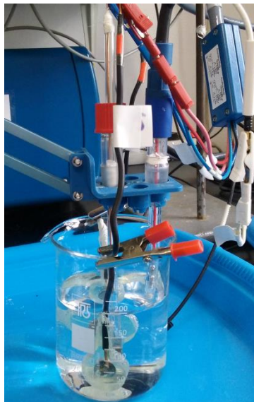
Slika 3.4. Troelektrodni sustav za elektrokemijska mjerenja
