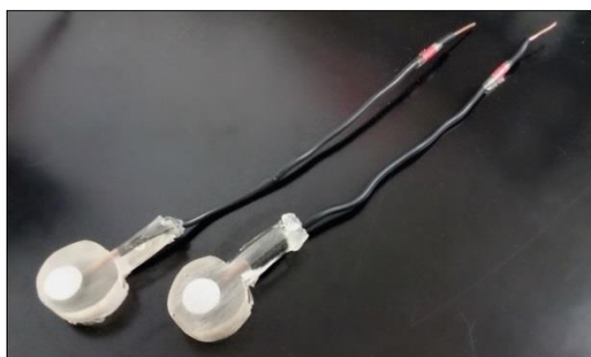
Slika 3.1. Radne elektrode za ispitivanje u otopini etanola i vode
