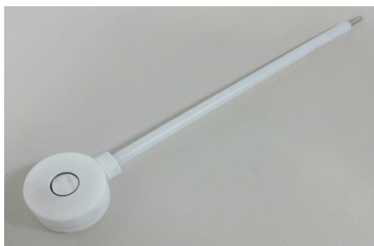
Slika 3.2. Držač elektroda za uzorke pripremljene u tetrahidrofuranu
