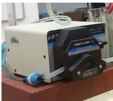
Slika 3.4. Pumpa sa podesivom brzinom protoka
