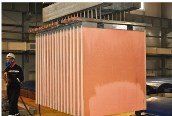
Slika 2.11. a) Elektrode na kojima je istaložen metal iz otpadne vode, b) uklanjanje sloja metala s površine elektrode [14,15]
