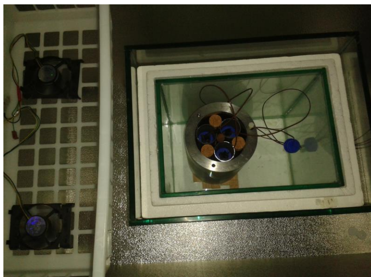
Slika 3-5. Pregled stakleno-stiroporne konstrukcije smještene u škrinju.
