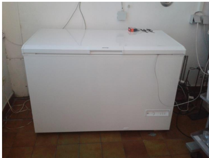
Slika 3-2. Škrinja za zamrzavanje na koji je priključen termostat.
