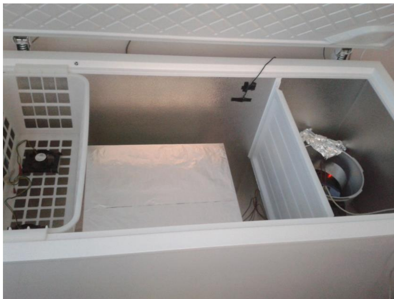
Slika 3-7. Aparatura za mjerenje oslobođene topline prilikom hidratacije.
