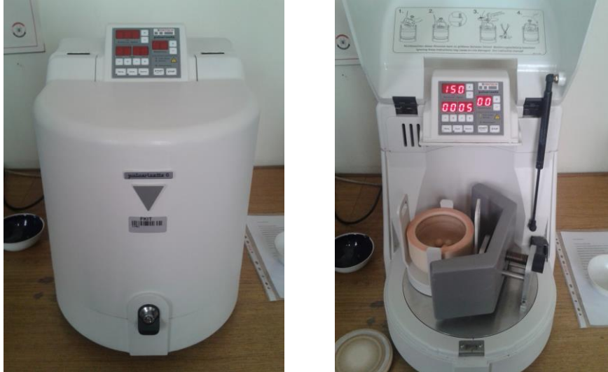
Slika 3-1. Planetarni kuglični mlin Pulverisette 6 classic line.
