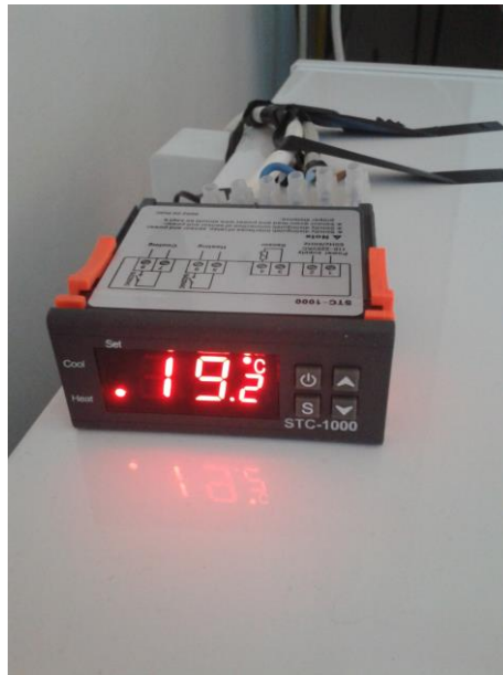
Slika 3-3. Termostat za regulaciju temperature u škrinji.
