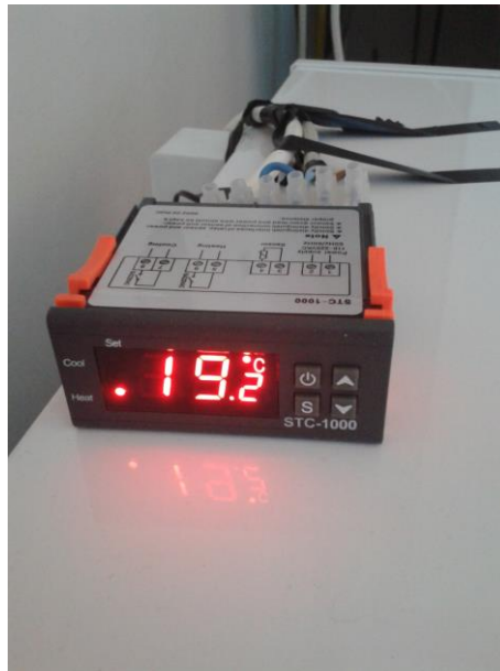
Slika 3-3. Termostat za regulaciju temperature u škrinji.
