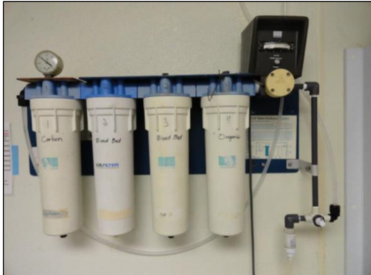
Slika 6. Mili-Q uređaj za dobivanje ultračiste vode
