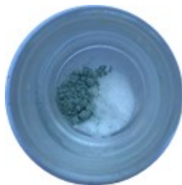
Slika 20. Prikaz reaktanata u reakcijskoj posudi; CuBr - lijevo, KBr - desno
