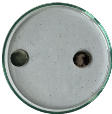
Slika 17. Izrađene pastile od K_2CuCl_3 (lijevo) i K_2CuBr_3 (desno)
