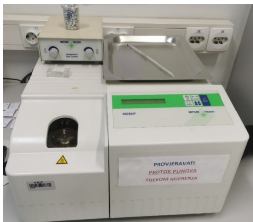
Slika 23. Diferencijalni pretražni kalorimetar, DSC, Mettler Toledo DSC 823
