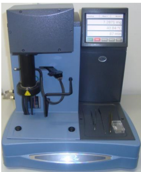
Slika 24. Termogravimetar, TA Instruments Q500
