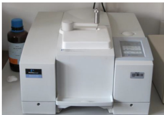
Slika 25. FTIR spektrometar - Perkin Elmer Spectrum One s ATR sustavom
