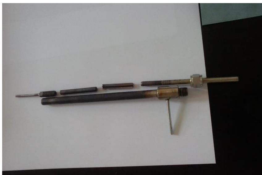
Slika 3.7. Punjenje cijevnog reaktora monolitnim katalizatorom
