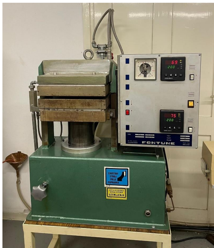
Slika 20. Hidraulična preša, Fontune, Holland (model SRB 140, EC 320x320NB)
