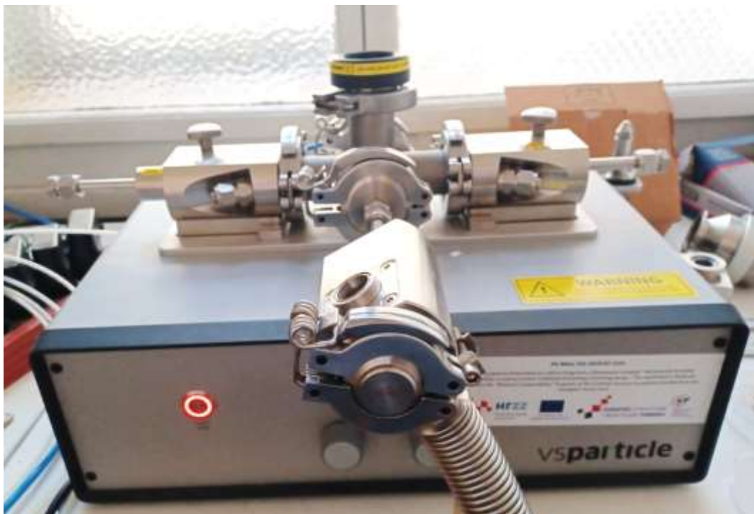
Slika 3.2. Generator nanočestica VSParticle Generator One (VSPG1) za sintezu nanočestica \text{TiO}_2 .
