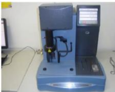
Slika 33. Termogravimetar TA Instruments Q 500
