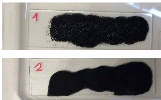
Slika 49. Prikaz filma uzoraka ugljikovih nanocjevčica
