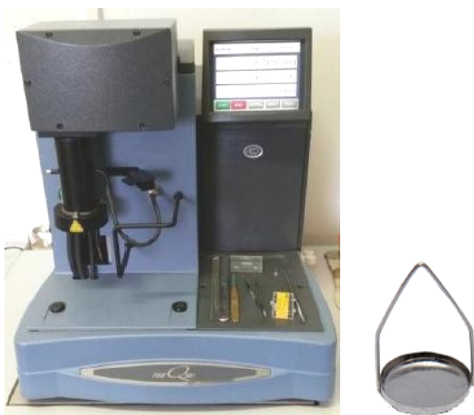
Slika 38. Termogravimetrijski uređaj TA Instruments Q500 i platinski lončić
