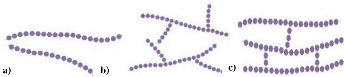
Slika 1. Ovisno o vrsti mera reakcijom polimerizacije mogu nastati slijedeće strukture: a) linearna, b) granata, c) umrežena 2
