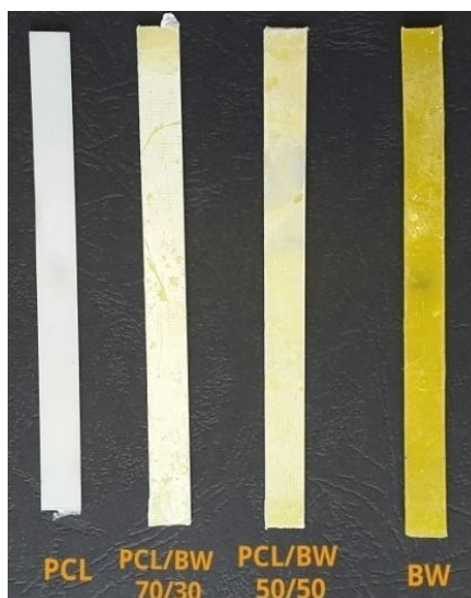
Slika 46. Pločica PCL, BW i PCL/BW mješavina nakon 5 tjedana enzimske razgradnje
