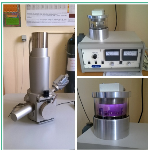
Slika 37. Pretražni elektronski mikroskop Tescan Vega serija 3, Bruker (lijevo), uređaj za neparivanje vodljivog sloja zlata (desno gore) i komora za neparivanje tijekom procesa neparivanja (desno dolje)
