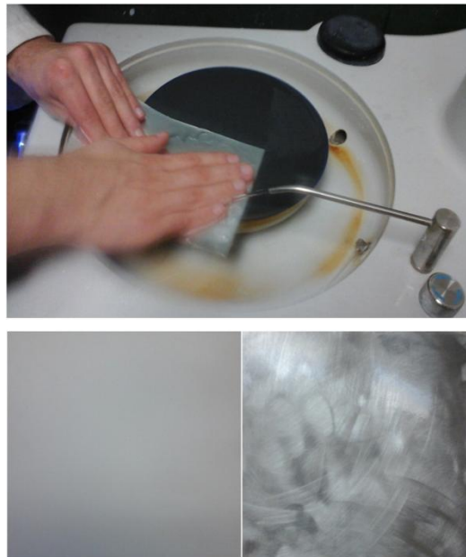
Slika 3.2. Poliranje aluminijskog kolektora za strujni kolektor
