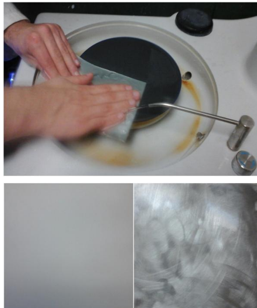
Slika 3.2. Poliranje aluminijskog kolektora za strujni kolektor
