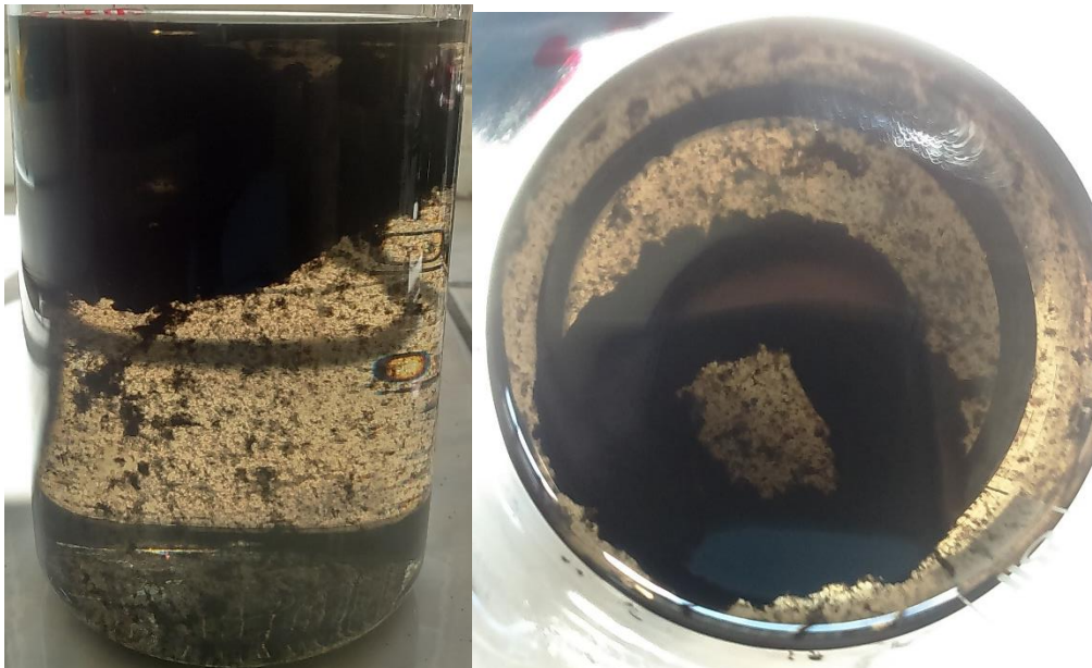
Slika 4.2.15. Uzorak PDPA2 nekoliko sati nakon ultrazvučnog homogeniziranja
