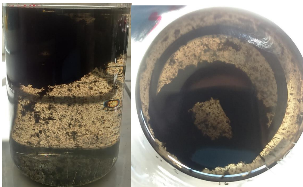
Slika 4.2.15. Uzorak PDPA2 nekoliko sati nakon ultrazvučnog homogeniziranja
