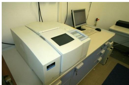
**Slika 3.3.** FTIR spektrofotometar
