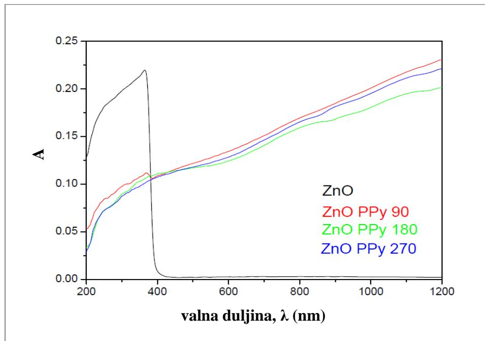
Slika 4.3. UV/Vis spektri ZnO i PPy/ZnO kompozita
