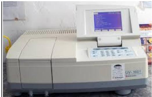
**Slika 3.4.** UV/Vis spektrofotometar
