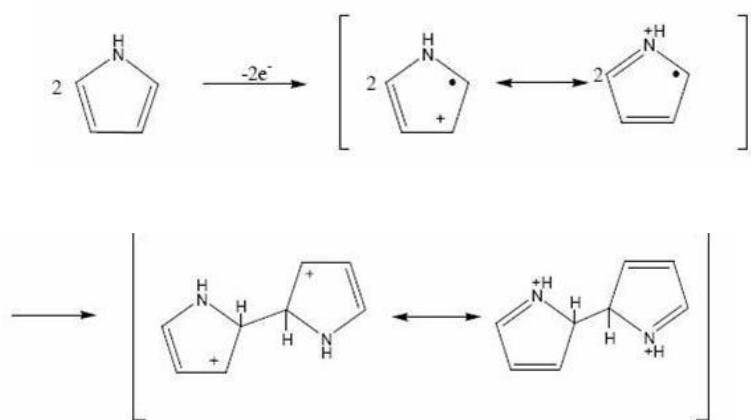
Zadnji korak je zapravo ponavljanje prvog koraka, koji započinje oksidacijom, u kojem se povezuju oba kraja polimera uz izdvajanje vodikova iona ( $\text{H}^+$ ) i uklanjanje elektrona elektrokemijskom depozicijom ili redukcijom oksidacijskog sredstva.
