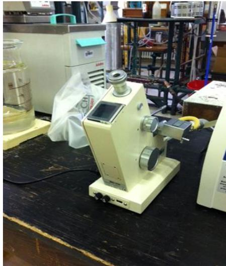
Slika 14. Uređaj za mjerenje indexa loma- refraktometar
