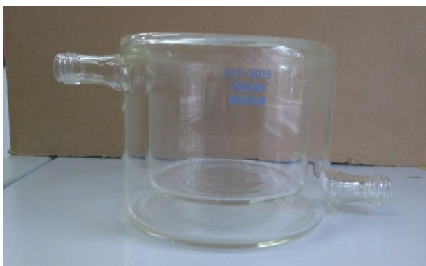
Slika 12. Kotlasti reaktor s vodenim hlađenjem
