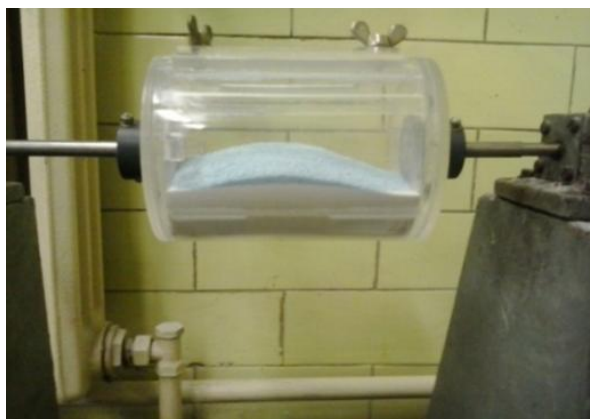
Slika 3.16. Horizontalni bubanj za miješanje
