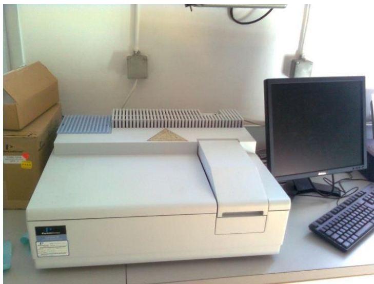
Slika 21. UV/VIS spektrofotometar Lambda 35 ( PerkinElmer, Waltham, SAD )
