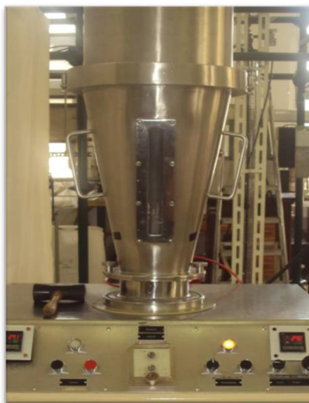
Slika 3.14. Granulator s fluidiziranim slojem
