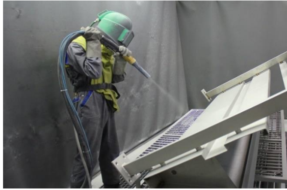
Slika 8. Prikaz mehaničke obrade postupak sačmarenja [14]
