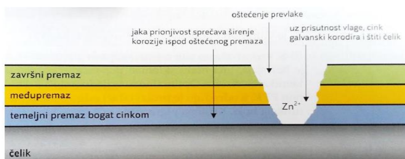
Slika 23. Galvanski učinak zaštite premazima [26]
