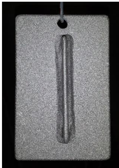
Slika 40. Pločica bez rebra poslije sačmarenja i pločica s rebrom poslije sačmarenja
