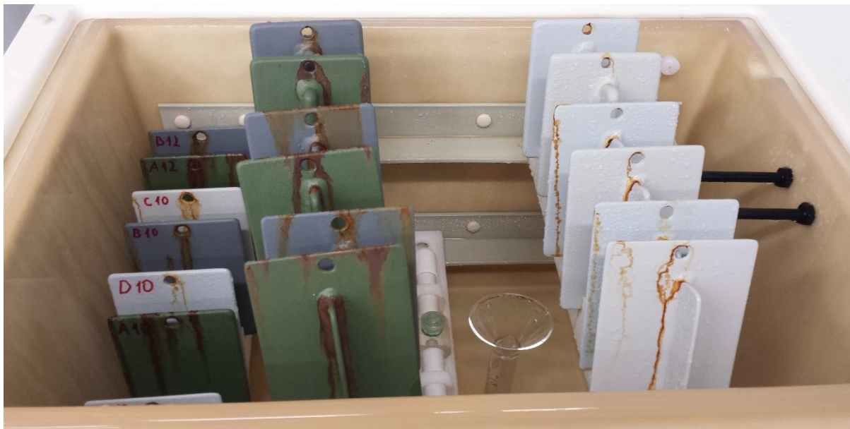
Slika 61. Stanje u slanoj komori nakon 720 sati
