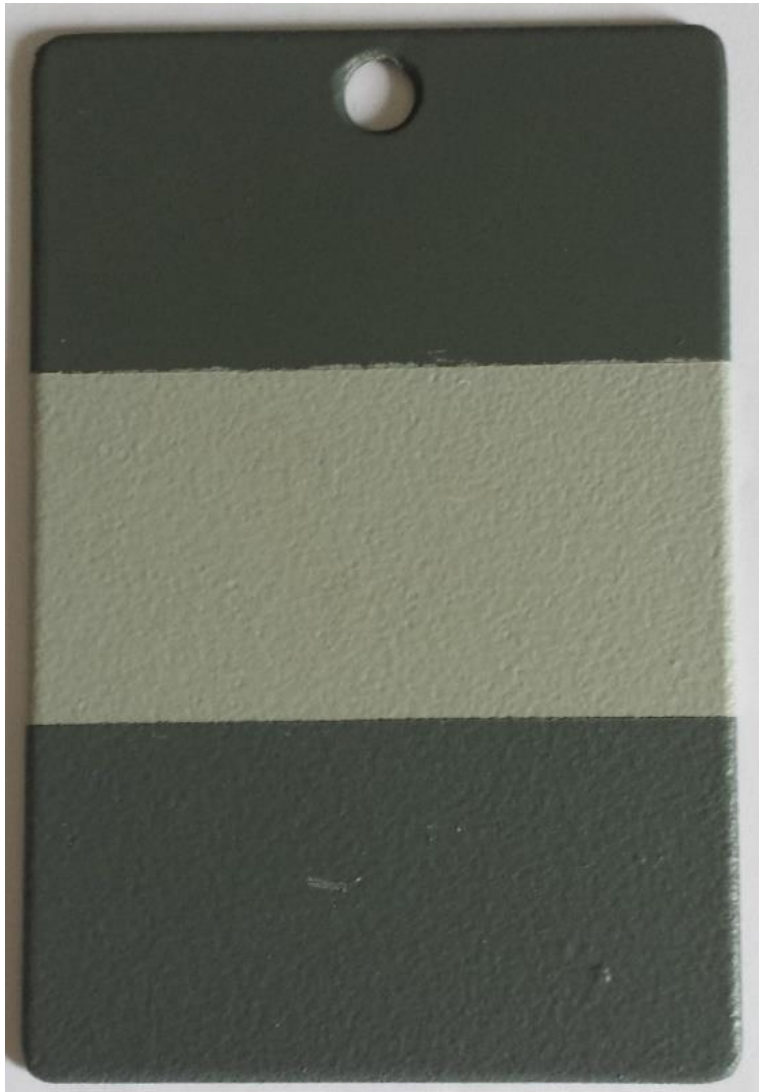
Slika 43. Premazni sustav B po slojevima premaza
