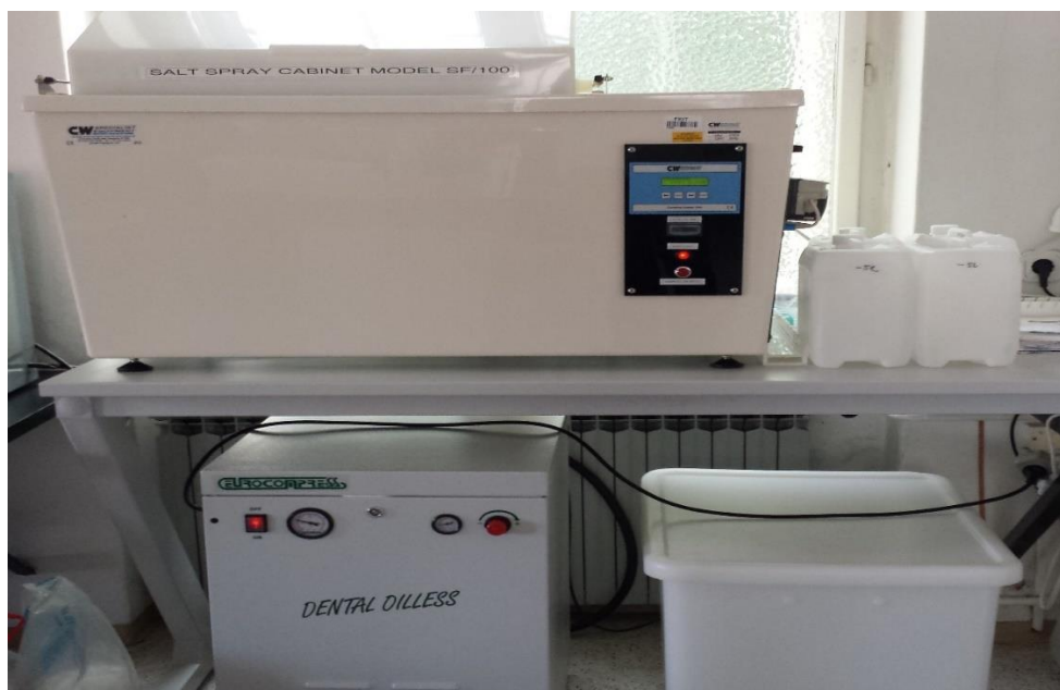
Slika 47. Slana komora SF/100 na Zavodu za elektrokemiju
