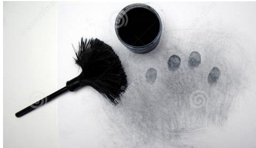
Slika 7. Primjena aplikatora sa staklenim vlaknima [6].
